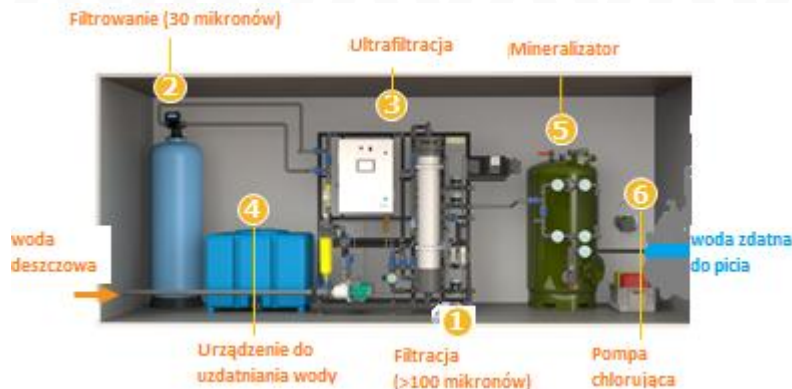
Rycina 1. Schemat systemu Ocene Ekorain: gotowy do podłączenia i pracy kontener EkorainUltra® zajmuje się wszystkimi etapami związanymi z zapewnieniem zdatności wody deszczowej do picia.
