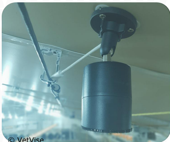
Rycina 1. Kamery szerokokątne, odporne na zabrudzenia, o stopniu ochrony IP67, zasilane przez przełączniki PoE umieszczone na zewnątrz kurnika
