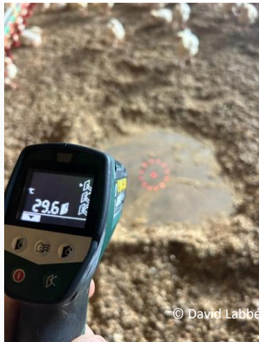
Termometr na podczerwień do pomiaru temperatury posadzki
